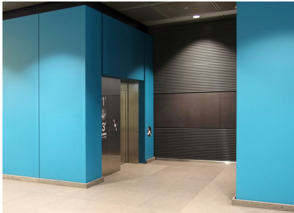
【改修後】乗場（幕板有り、出入口幅1000mm）
