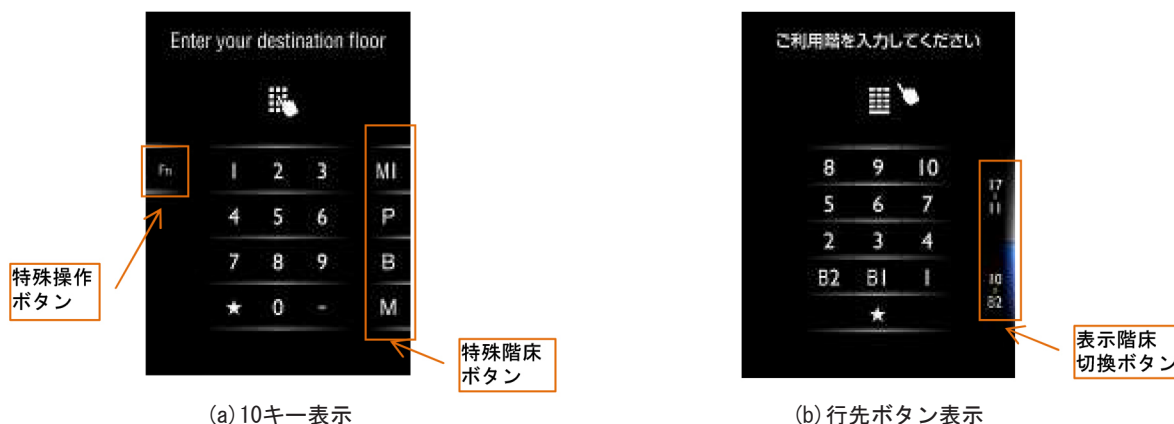
図4. タッチパネル式乗場操作盤の外観
