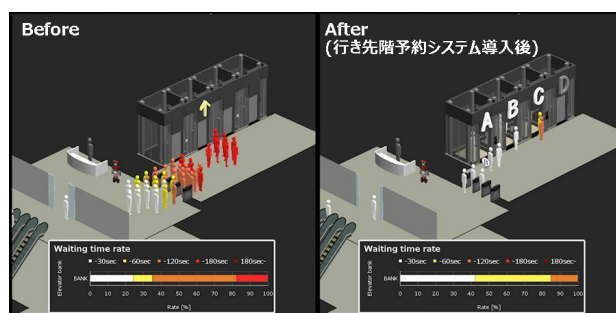
図6 行き先階予約システムとセキュリティゲート連動の効果 実際には事前に確認することが困難なビル内設備変更や運用変更による人の移動への影響度合いを3Dアニメーションでわかりやすく見える化。ただし、効果は使用状況により変動するおそれがある。
