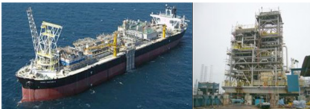
写真8 低温衝撃保証鋼使用の例 (-20℃ 衝撃保証の形鋼)
