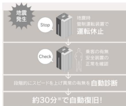
図5. 地震時エレベーター自動診断&復旧システム『ELE-Quick (エレクイック)』イメージ
