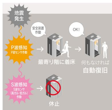
図4. 地震時管制運転イメージ
