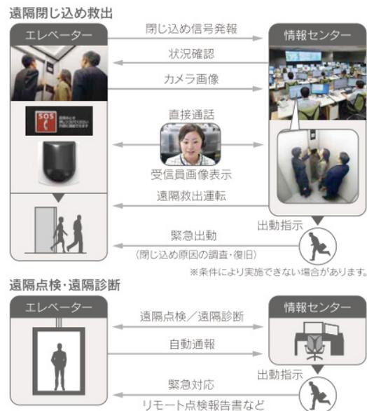
図7. 遠隔閉じ込め救出、遠隔点検、遠隔診断イメージ
