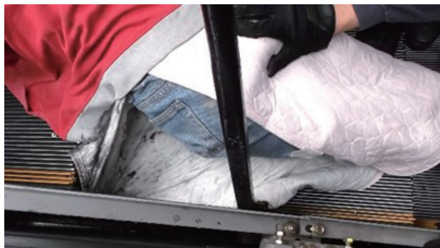
写真4 スカートガードに衣服（ひろげる）
