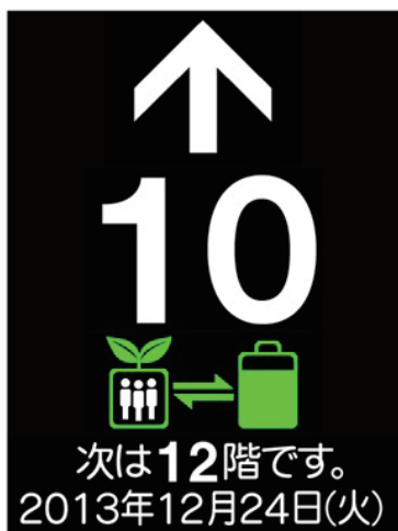
図4 かご内液晶表示器の表示内容(平常時表示)
